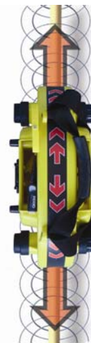
Рис. 8: Ориентация относительно коммуникации в индукционном режиме
