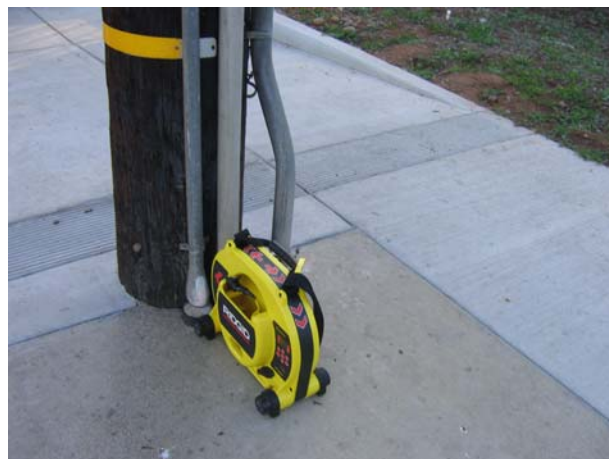
Рис. 10: Наведение сигнала в вертикальной магистрали
