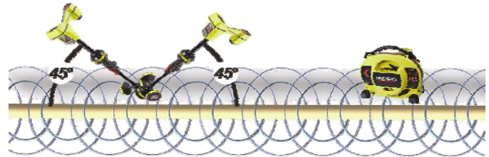
Рис. 12: Проверка наличия индуктивной связи через воздух
